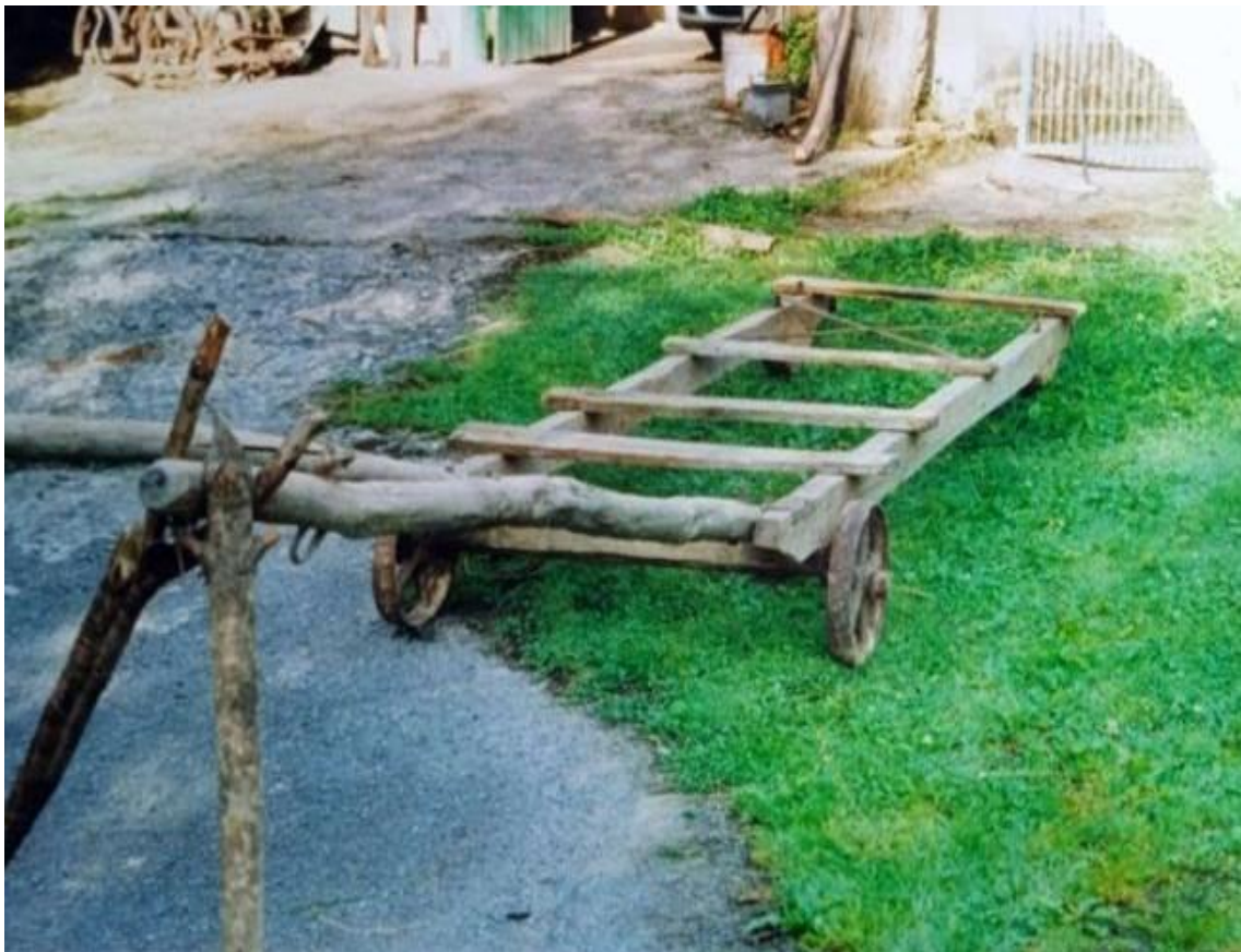
Figura 9 Por caminos de tierra o herbazales la narría no precisa ruedas Era una pieza de quita y pon para no estropear la madera en las modernas carreteras asfaltadas (Fotografía: J. A. Castaños)
