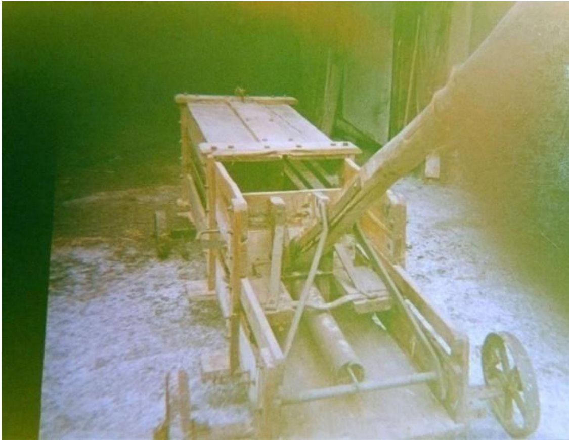
Figura 10 enfardadora “semiautomática” construida por J. A Castañõs, réplica de la de las Bordas de Treskilotxa. Antes de disponer de este tipo de enfardadoras, la hierba se prensaba con los pies en un cajón para formar los fardos. Con esta innovadora máquina, se cargaba la tolva de hierba y se realizaban tres prensadas para finalizar la tarea
